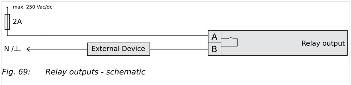
Fig. 69: Relay outputs - schematic
