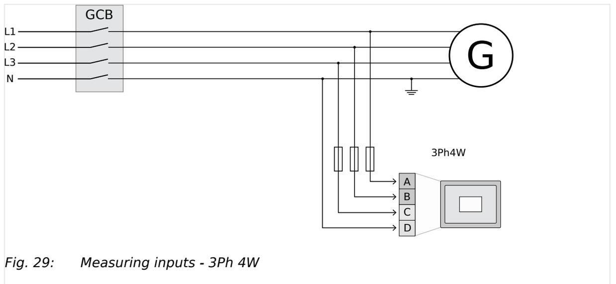
Fig. 29: Measuring inputs - 3Ph 4W
