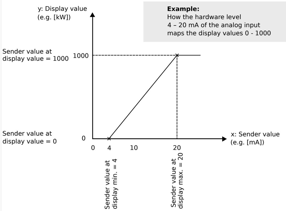
Fig. 158: Analog Input Mapping
