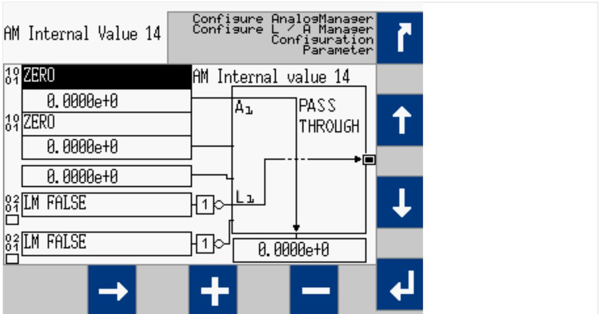
Fig. 210: Display (HMI) AM14
