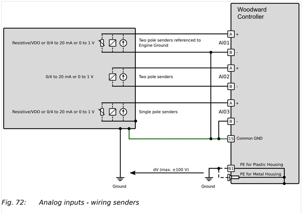
Fig. 72: Analog inputs - wiring senders
