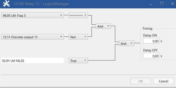
*Fig. 237: LogicsManager function "Relay 12"*
