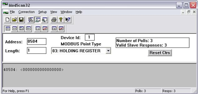
Fig. 292: Modbus - remote control parameter 503
