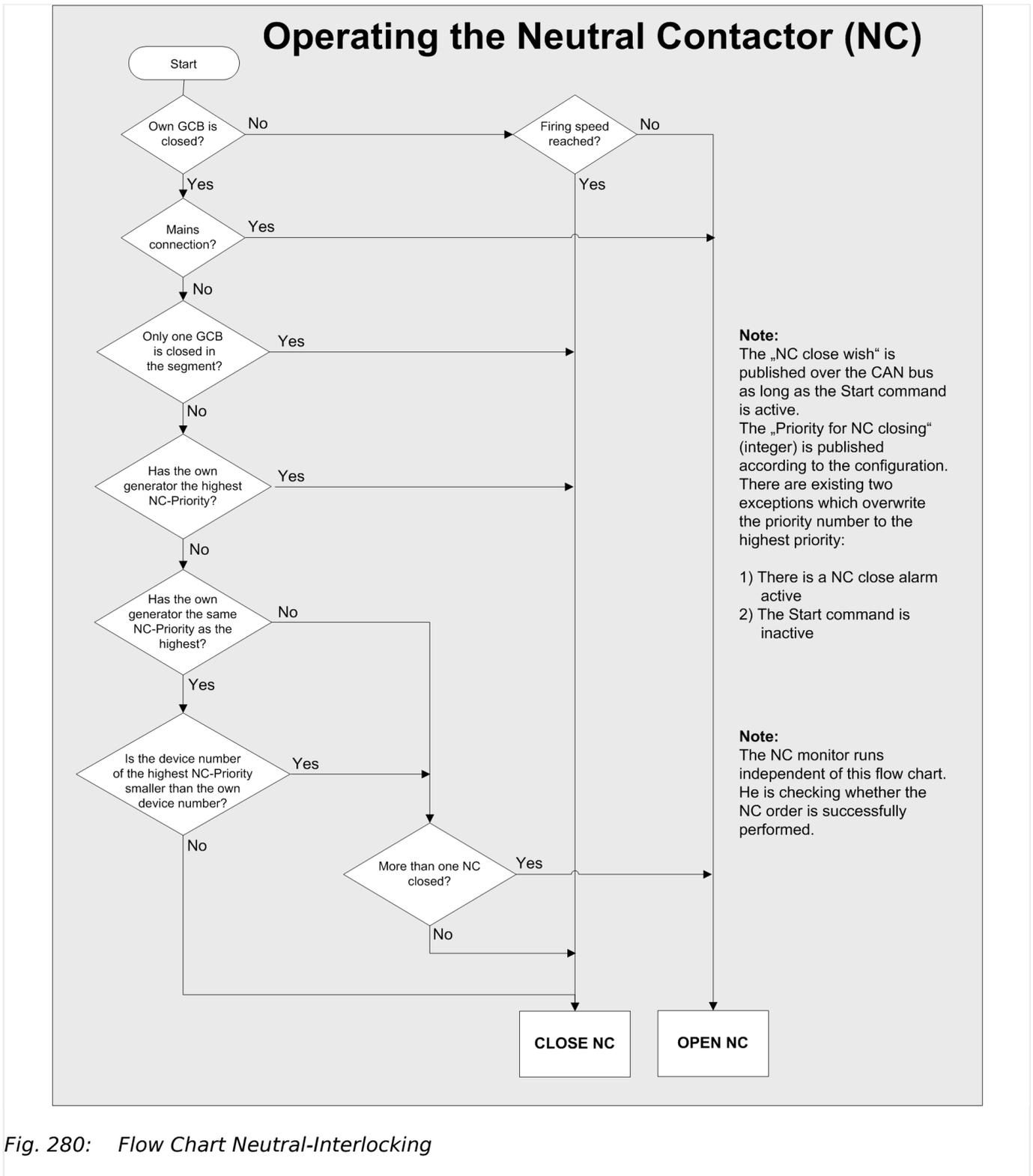
Fig. 280: Flow Chart Neutral-Interlocking
